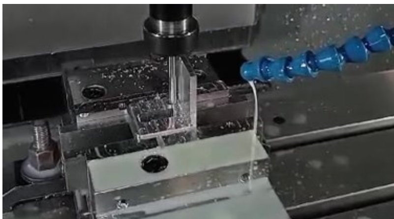
Figură 62 - Poză cu frezarea suportului pentru motorul pas cu pas - programare CAM
