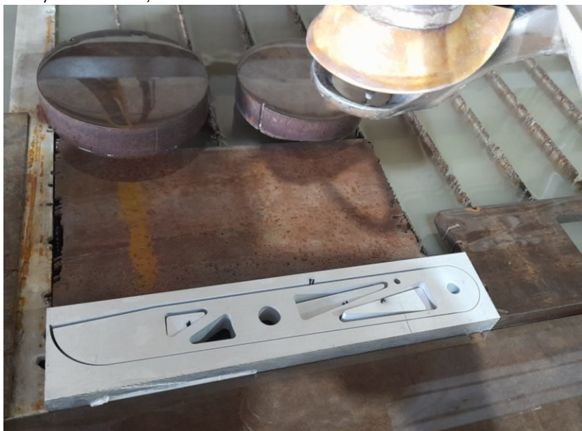
Figură 56 - Poză cu conturul pedalier de frână realizat prin debitare cu jet de apă
