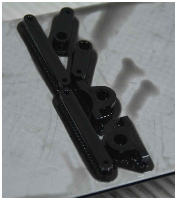
Figură 65 - Piese pentru contarea potențiometrului de poziție realizate prin printare SLA
