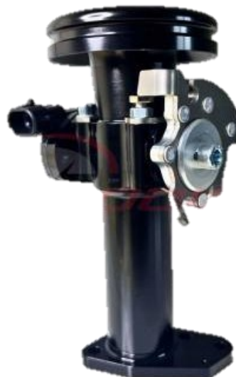
Figură 18 - Clapetă Formula Seven cu semi-cerc de 28 mm pentru acționare
