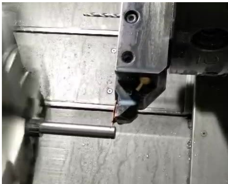
Figură 61 - Poză cu strunjirea axului pedalei de frână – programare în mod conversațional
